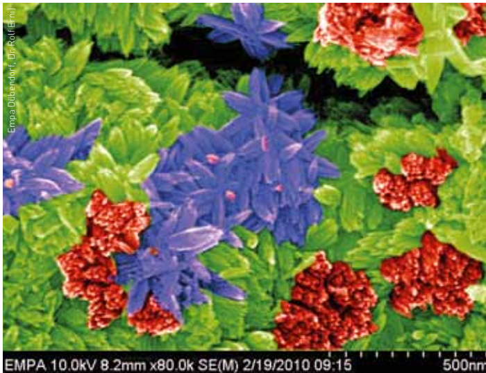
Nanostrukturierung von Eisenoxid führt zu sternförmigen Mustern und zu einer Verdopplung der Photostromdichte (Bildnachweis: Empa Dübendorf, Dr. Rolf Erni).
